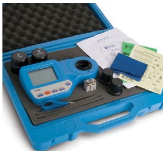
Figura 1 – Fotómetro para medição de parâmetros qualitativos da água
